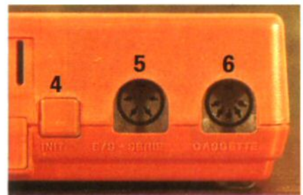
L'alimentation électrique (1) ; la prise TV (2) ; le connecteur d'extension mémoire (3) ; le bouton de remise à l'état initial (4) qui est utilisé quand l'ordinateur se bloque ; l'entrée et sortie en série (5) qui permet de brancher une imprimante série ; la prise cassette (6).
